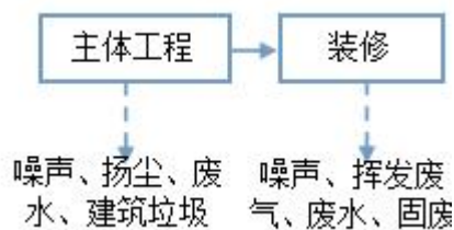
图 2-2 施工期产污环节图
